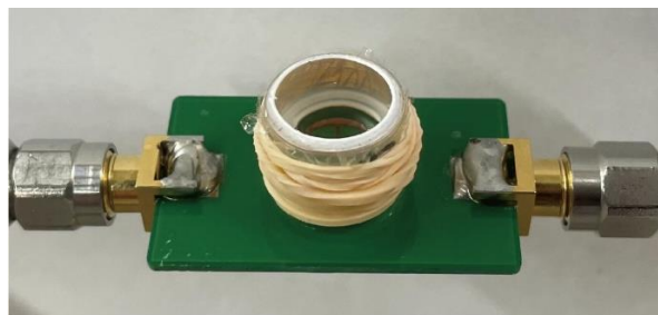
図 10 円形チューブを使った CSRR の測定設定
