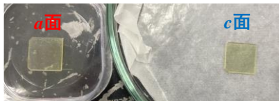
図 1 酸化亜鉛単結晶基板(a 面・c 面)
