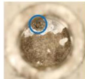
図6 アルミ円柱のクレーター<sup>6)</sup>
