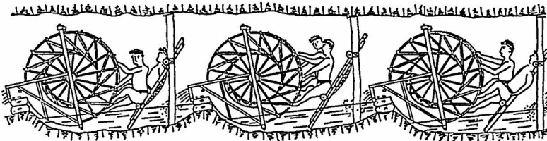
第5図 三池炭坑の排水用水車
