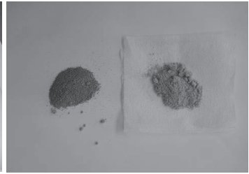
図 17 乾式洗浄後の粉末消しゴム (左) 使用前の粉末消しゴム (右)
