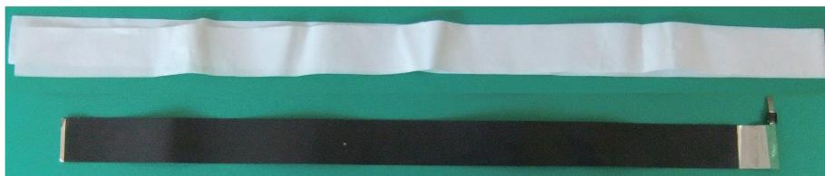
図5 正極シートとセパレータ
