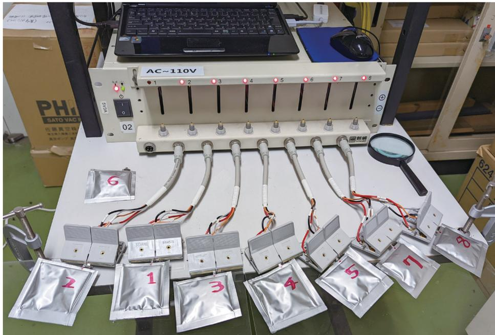
図 20 充放電評価装置を用いた CCCV 方式による初期充電
