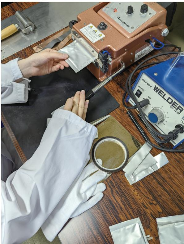
(a) 図7 (a) の状態から熱圧着封止
