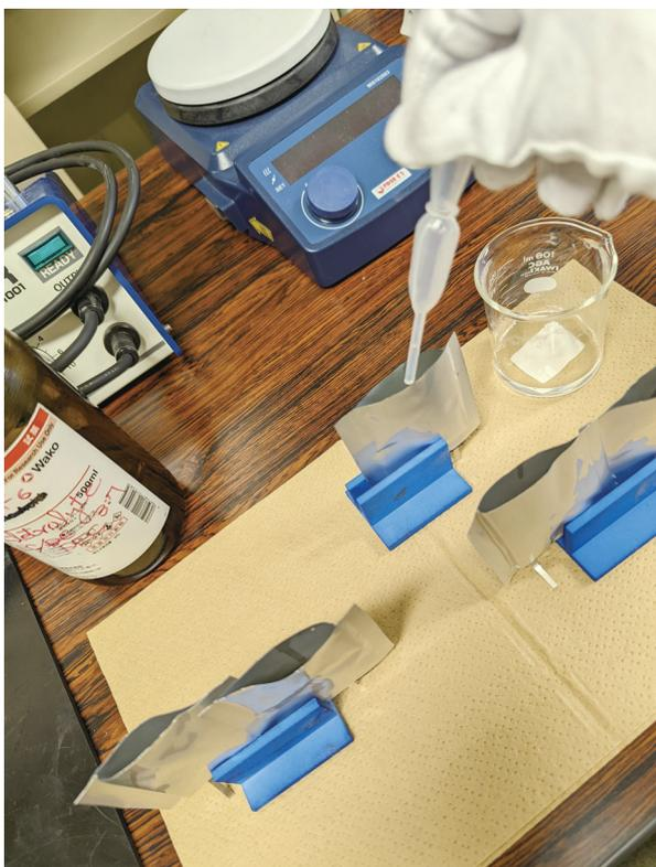
図 18 注入口から電解液注入
