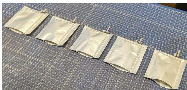
(b) 電解液注入口を残し封止
