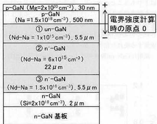
図10 内蔵電界の解析に用いた3層ドリフト層を有するpnダイオードの層構造
