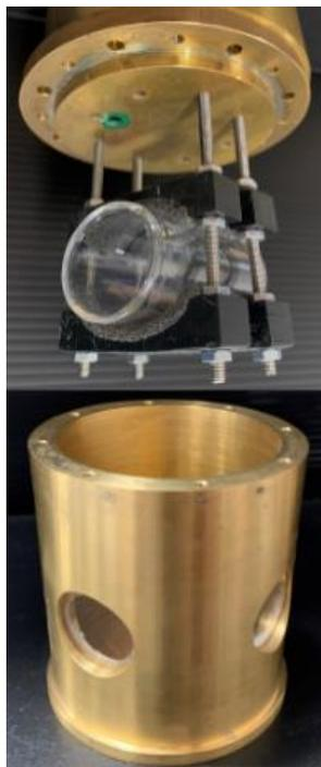
Fig. 7 圧力可変容器内への Cs 封入ガスセルの設置方法
