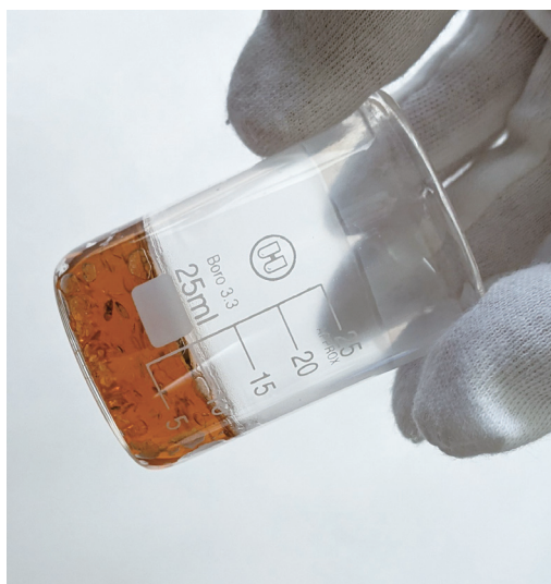
図2 電解液1 mol \text{LiPF}_6 in EC/DEC (1:1 vol%) のゲル化
