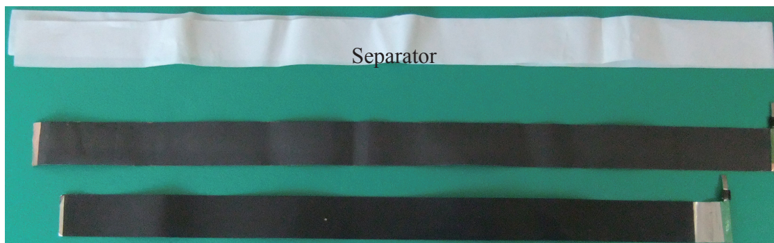
(a) 正極シート (下)、負極シート (上)、セパレータ
