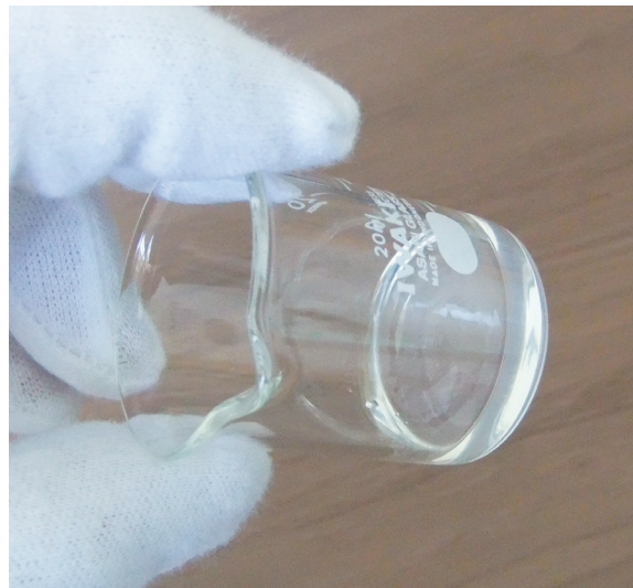
図 1 電解液 1 mol LiTFSI in PC のゲル化
