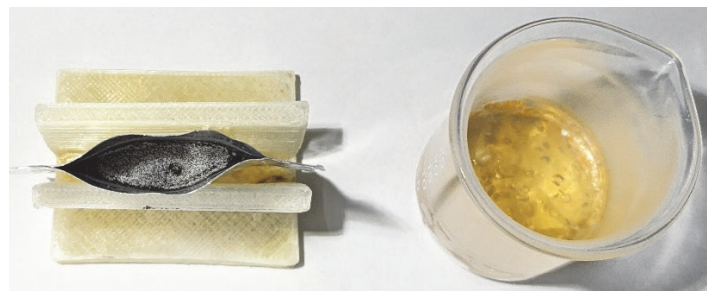
図5 ポーチセルのゲル化状態とモニタリング用のビーカのゲル化状態
