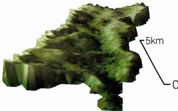
図6 抽出した流域を三次元的に表現した図. Zバッファ法を用い, スムースシェーディングとテクスチャマッピングを施した.
