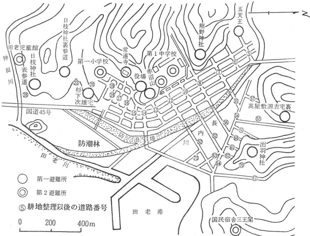
図は「田老町防災計画書」, 「津波と防災」による。等高線類似の線は正確でなく、フォームラインと考えるのがよい。原図のままを入れた。なお、戦後に構築された新防波堤が、図中の「堤」の字付近から北東に伸び、67, 64道路交点付近を経て三王閣の尾根に取り付いて完工したが、原図から脱落している。
