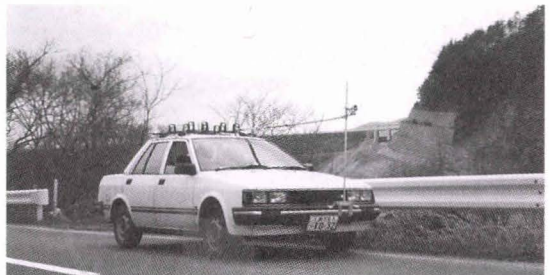
写真2 移動観測に用いた車と温度センサー設置の様子(1991年11月1日・佐藤撮影)
