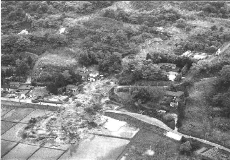
写真4 宮城県北部地震で流動性地すべりを起こした谷埋め盛土斜面
