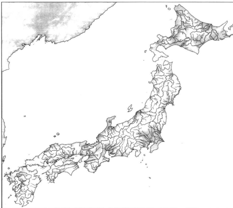
第 2 図 GTOPO30 から抽出した、2048 グリッド以上の流域面積を持つ河川。細線は流路を示し、太線は流域界を示す。
