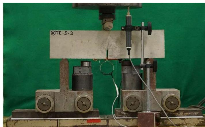
図-4.2.21 ひび割れ確認時と載荷終了時のひび割れ性状 (TE-S-2)
