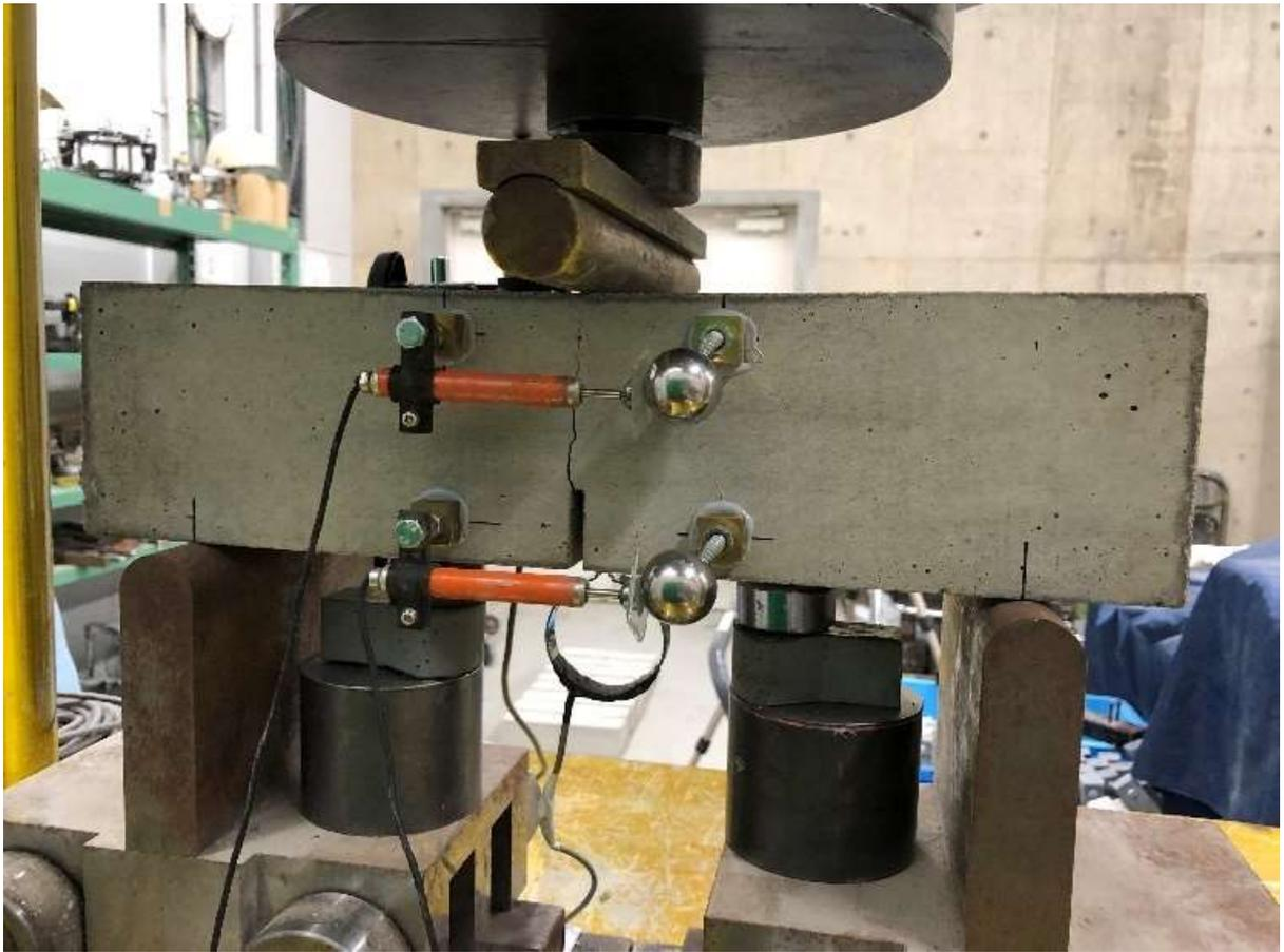
図-4.2.3 試験体背面の曲率を算出するための水平方向変位計（試験後）
