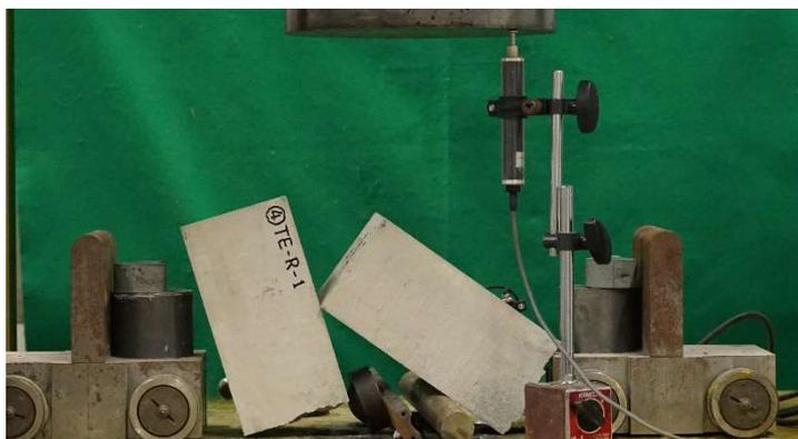
図-4.2.13 試験開始時と載荷終了時のひび割れ性状 (TE-R-1)
