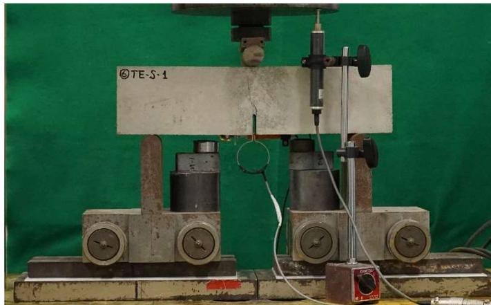
図-4.2.19 試験開始時と載荷終了時のひび割れ性状 (TE-S-1)
