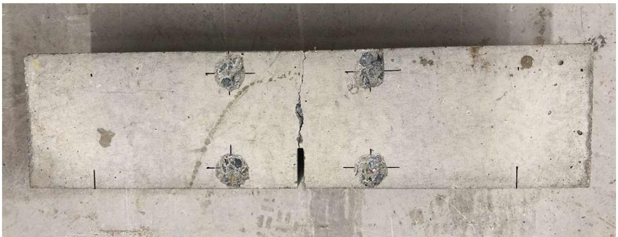
図-4.2.30 一度ひび割れ面で分離し、重ね合わせた試験体：分岐部分が角欠けし，内部に一本のひび割れが見える (TE-S-1)
