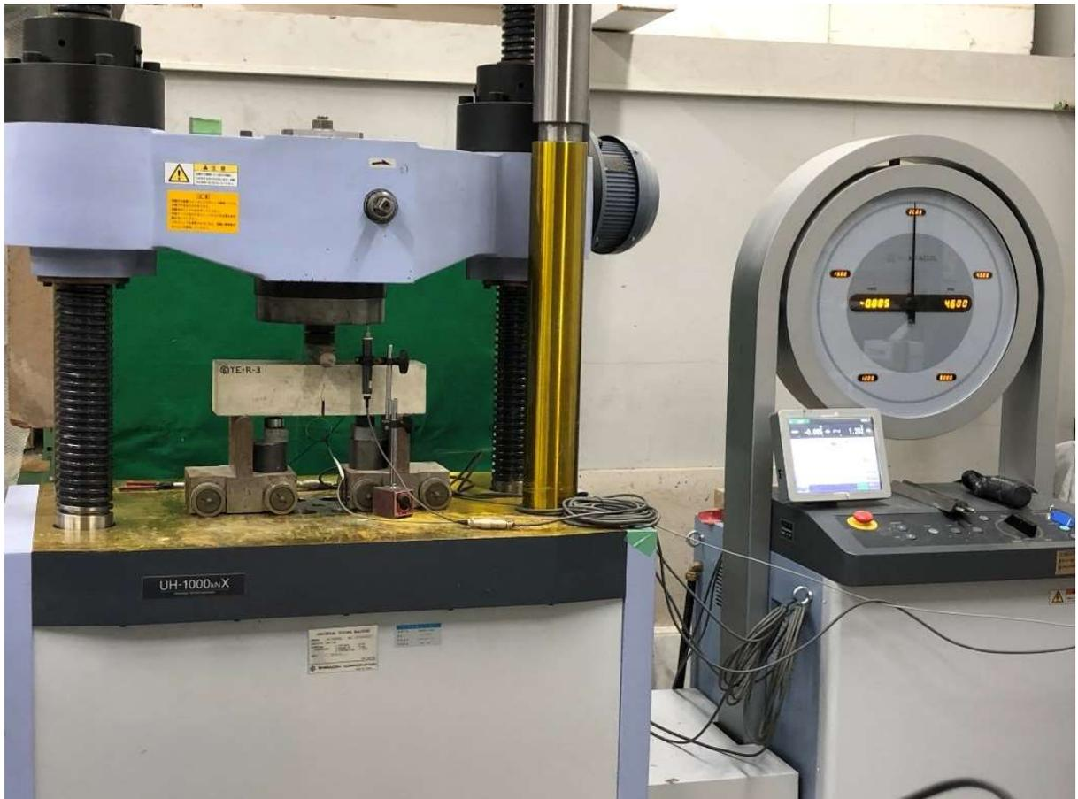
図-4.2.1 試験体を設置した状態の実験装置全景 (TE-R-3)
