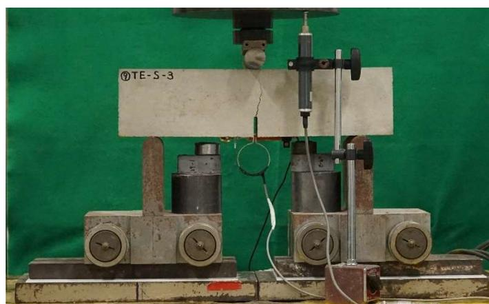
図-4.2.23 ひび割れ確認時と載荷終了時のひび割れ性状 (TE-S-3)
