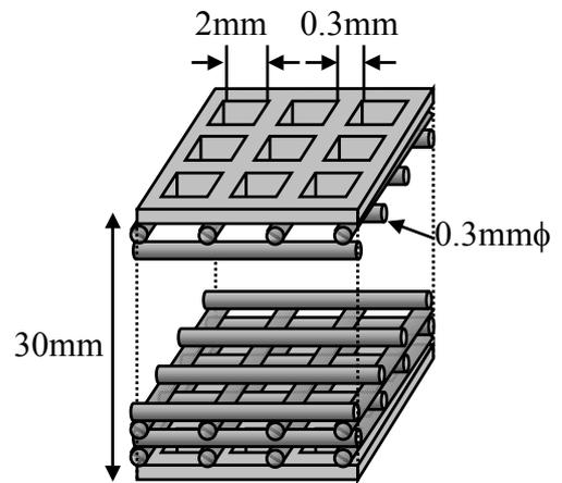
Fig. 5. Collimator-C
