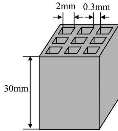
Fig. 3. Collimator-A
