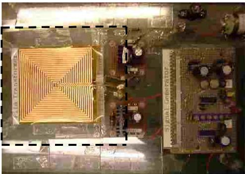
Fig.1. 磁界を測定したDC/DCコンバータ
