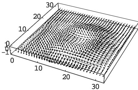
Fig.6. 25%に圧縮後復元した磁界分布データ (時刻76)
