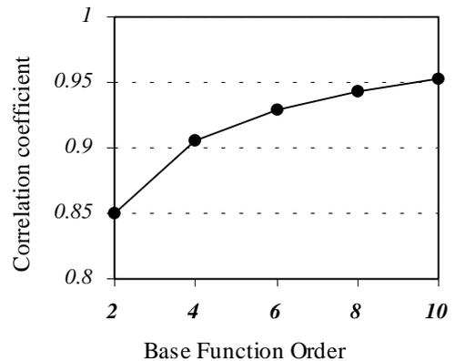
Fig.5. 25% に圧縮後復元した 1 測定点の磁界分布データの基底関数の次数による復元率
