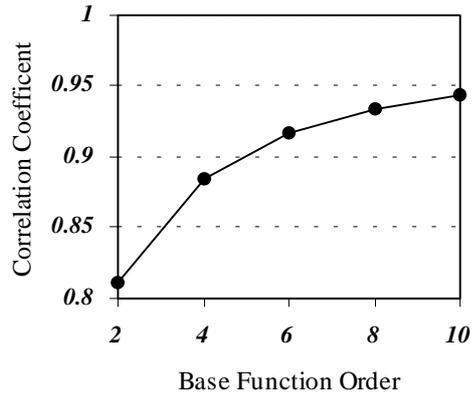
Fig.9. 25%に圧縮後復元した磁界分布データの基底関数の次数による復元率
