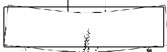
図10 RBSMによる崩壊直前の破壊線 (No.3試験体)
