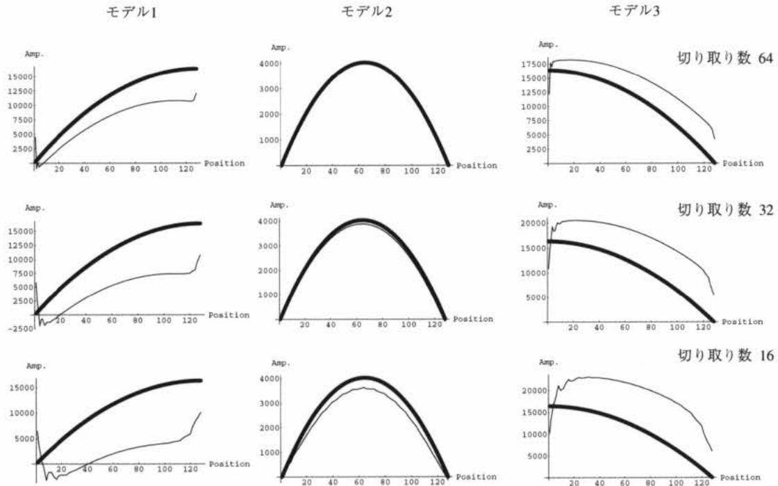
Fig. 6. ドビッチー4次基底の近似解（細線）と厳密解（太線）
