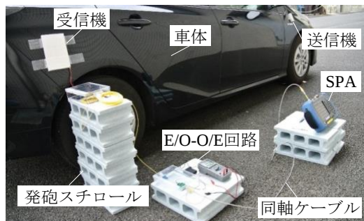
図 2 車体の周波数特性測定時の実験写真
