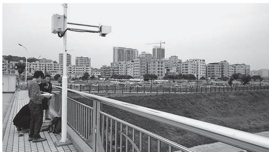
写真10 郊外の河川はゆったりしているが洪水対策も(欄干脇に設置されているのは、センサー式水位計。最近全国に配備されている日本のものより少し大型)
