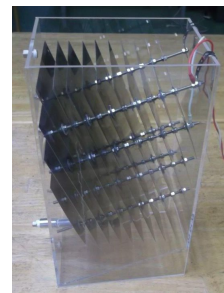
図4 傾斜板電極タイプの粒子凝集装置
