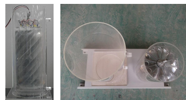
図3 螺旋電極タイプの粒子凝集装置
