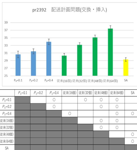
図 13. 実験 3 配送計画問題 pr2392(交換・挿入近傍, 探索回数半分)に対する実験結果
