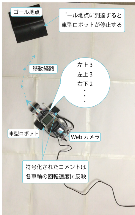
図 5. 車型ロボットのシステム応答
