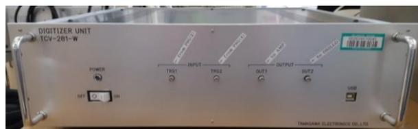
図 11 多摩川電子社製の任意波形発生器 TCV-281-W
