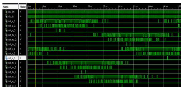
図 14 \Delta \Sigma 変調器の出力(out_u_1 から out_u_3 が U 相の+側出力, out_u_1 から out_u_3 が U 相の-側出力, out_v_1 から out_v_3 が V 相出力, out_w_1 から out_w_3 が W 相出力)
