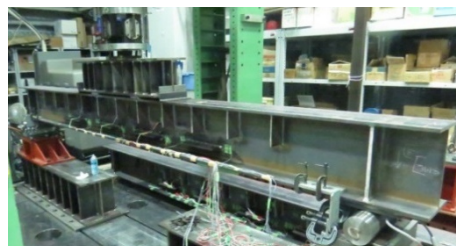
図-4 定点荷重疲労試験の状況
