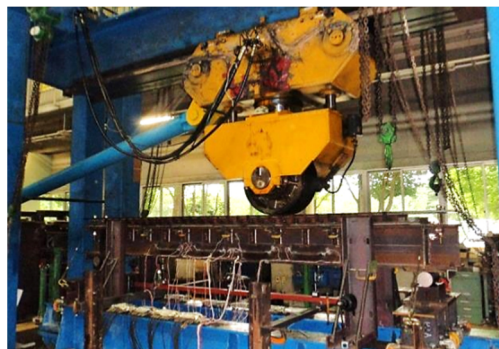
図-2 移動輪荷重試験の状況
