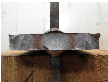
図-11 停留した疲労き裂
