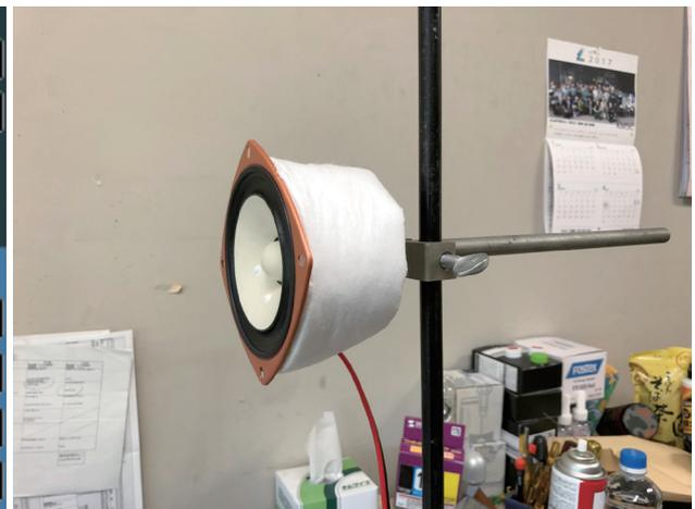
で 20k ~ 500Hz あたりまでフラットな再生領域が示された。500Hz 以上の高周波数の再生音圧は 80dB 以上を示し、高周波域の吸音材による再生不良は観察されなかった。シンサレートを巻いた背面開口部からの漏出音圧は 84.6dB であった。
