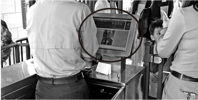
Photo 29 SHDL入園ゲート (QRコードを読み取るとディスプレイに顔写真が表示)
