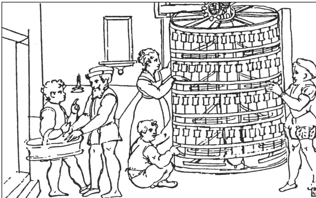
図 3-4-1 ポローニャの水力撚糸器械
