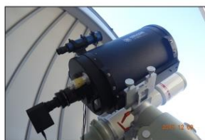
図3: 口径30cm反射望遠鏡 (Meade FBACF)
