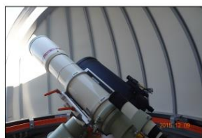
図4: 口径13cm屈折望遠鏡 (タカハシTOA-130NS)
