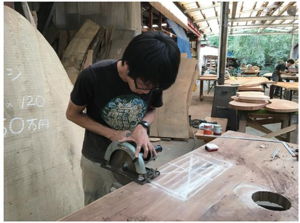
い性質を有し、高級家具類に使用されている。道管などの木材繊維は板材の長軸方向に平行に走るが、組織中に散在するためには板材にした際には目立たず埋没し、平滑な表面が得られる。今回の資材はブラックウォールナットの耳付き板目材を用いた（耳付き材：樹皮に近い部分を含む板材）。バツフル板として左右方向に長軸を揃えて用いることとした。バツフル板中央下部を長方形に切り抜き、アンプ、プレーヤーを設置するラックをはめ込み、板材中央にセン
