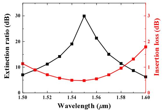
図 5 消光比および挿入損の波長特性
