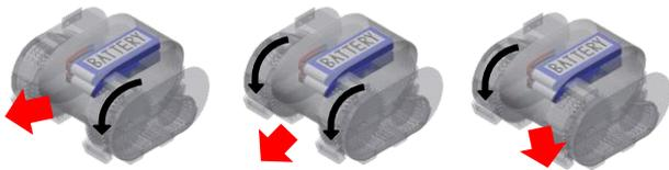
Fig.3 1 モジュールの旋回機構
