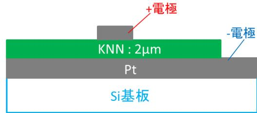
図8 KNN膜評価用基板構造
