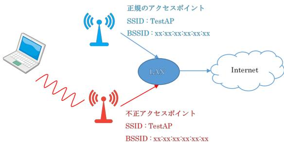
図 2 直接 LAN に接続する方法
