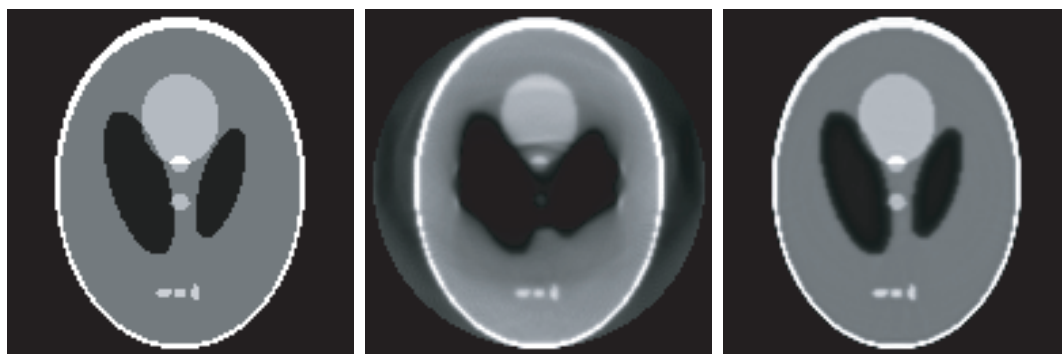
Fig. 4.25: 原画像，再構成画像 (補正なし)，再構成画像 (補正あり)
