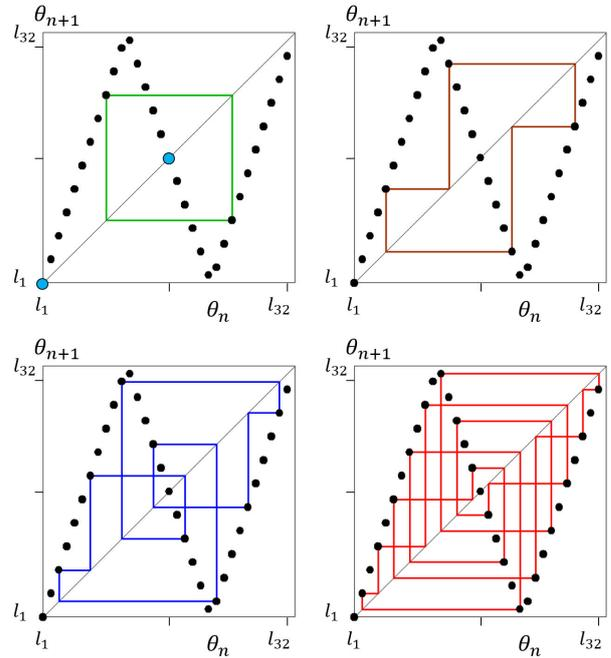
図 8  $a = 3.0$  の例. (b<sub>1</sub>) 不動点と 2 周期解 (b<sub>2</sub>) 4 周期解 (b<sub>3</sub>) 8 周期解 (b<sub>4</sub>) 16 周期解
