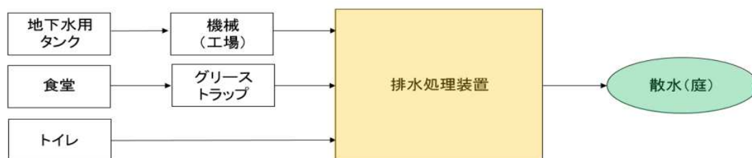
図 30 インドの日系企業における排水処理フロー
