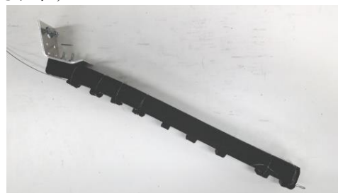
Fig.14 スポンジにゴムを接着していないアーム
