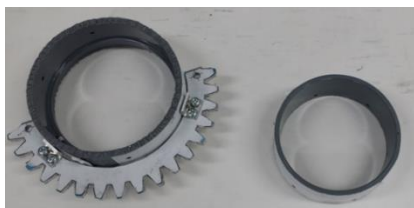
Fig.11 アームの根元部分 パイプ大 (左) , パイプ小 (右)
