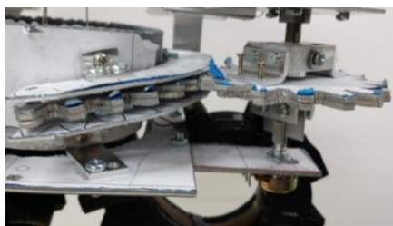
Fig.12 パイプとモーターのギヤの噛み合わせ
