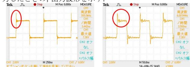
図 11. リンギング・サージ電圧の実測波形
