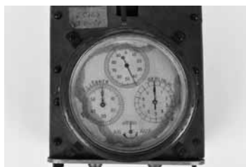
a 「電磁 SW 付クロノスコープ」に使われている Löbner 社の時計
