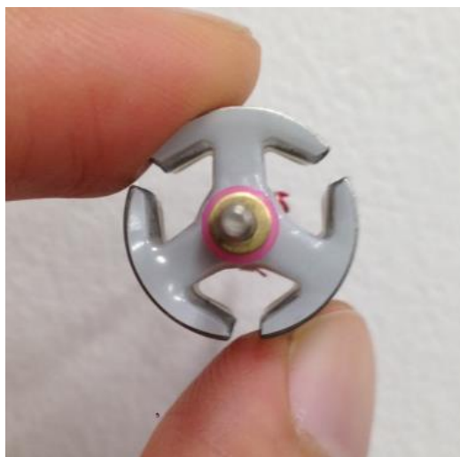
図 3.6 3 スロットモータの内部
