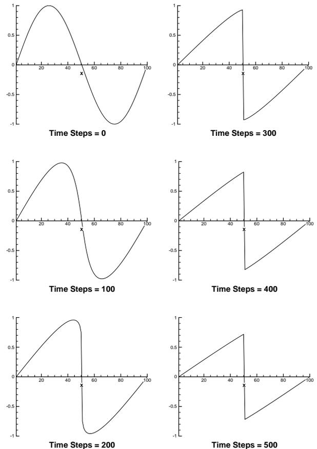
図 1 一次精度風上差分による Burgers 方程式の時間発展モデルの計算結果
