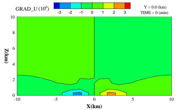
図 6 アジョイントプログラムで計算した風速の  $x$  成分の勾配
