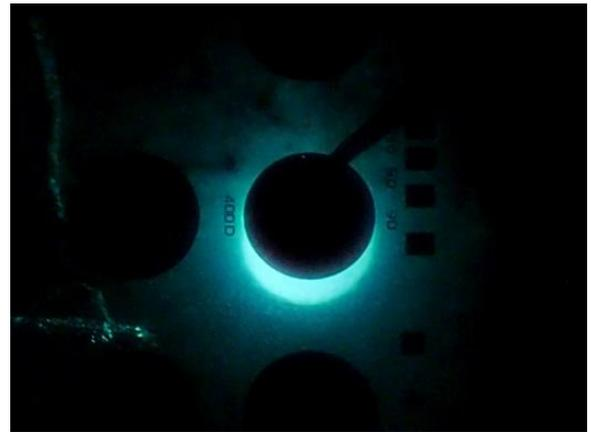
図 6 順方向バイアス時の発光の様子
