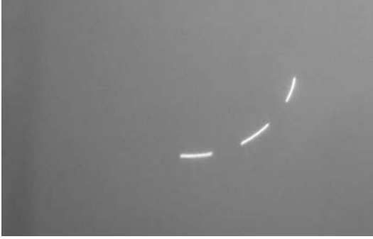
図2 暗くした部屋でスクリーン上にレーザーポインタの光を素早く動かした状態で撮影したものを3フレーム分加算した映像
