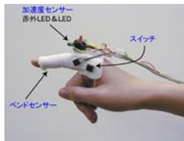
図 3 Ubi-Finger は 3 系統のセンサーで、そ (1) 人差し指の曲げ・伸ばし, (2) 手首の回転角度, (3) 親指によるボタン操作, といった情報が入力される。
