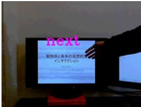
図9 モニターの右を右側から直接触っている状態
