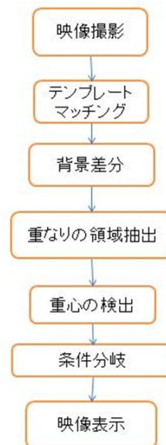
図12 触り方インタフェースのデータフロー
