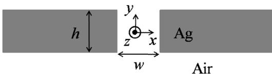
図 1 プラズモンギャップ導波路
