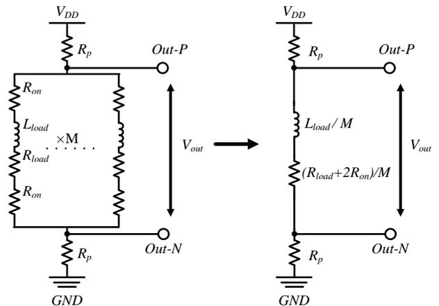
図11 ドライバ回路の等価回路
