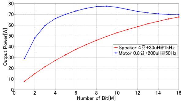
図 12 ビット数の増加と最大出力電力
