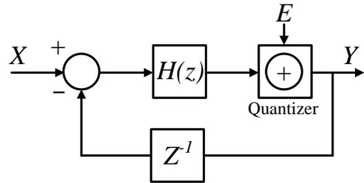
図5  $\Delta\Sigma$ 変調器のブロック図
