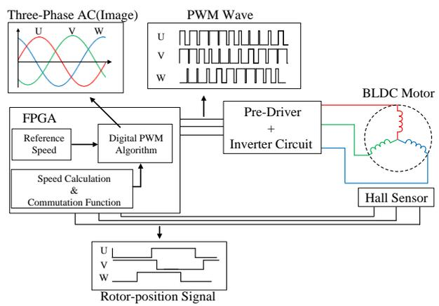
図 1 従来のモータ駆動システム
