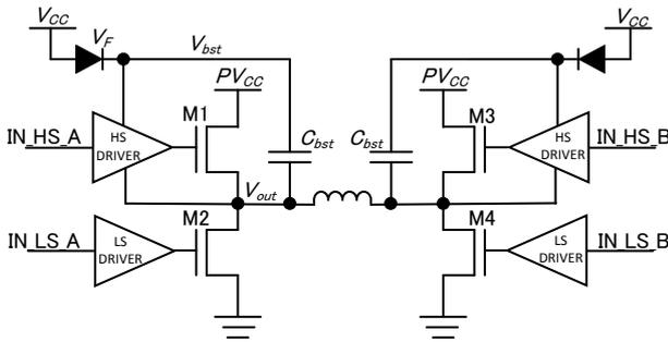
図 16 ドライバ回路の構成
