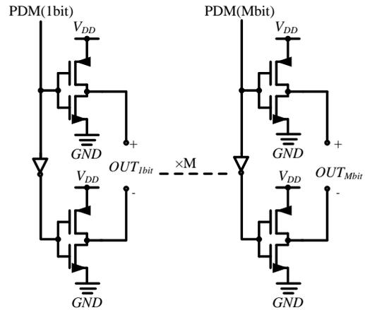
図10 ドライバ回路のモデル図
