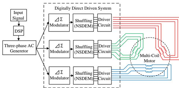
図3 デジタル直接駆動モータシステム
