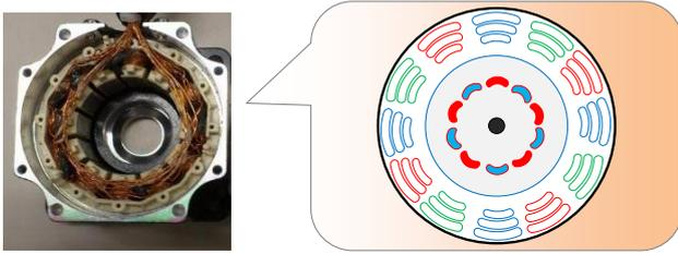
図 15 3 ビットマルチコイルモータ
