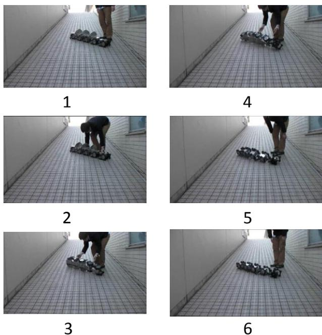
Fig.11 斜面における起き上がり実験(失敗)
